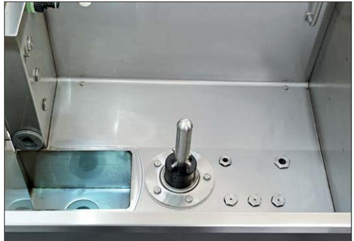
So sieht Hygiene aus: Innenraum aus Edelstahl, abgerundet, Waschdüsen unten und seitlich ebenfalls Edelstahl. Alles leicht zugänglich, alles schnell ohne Werkzeug zur Reinigung zu entnehmen.
