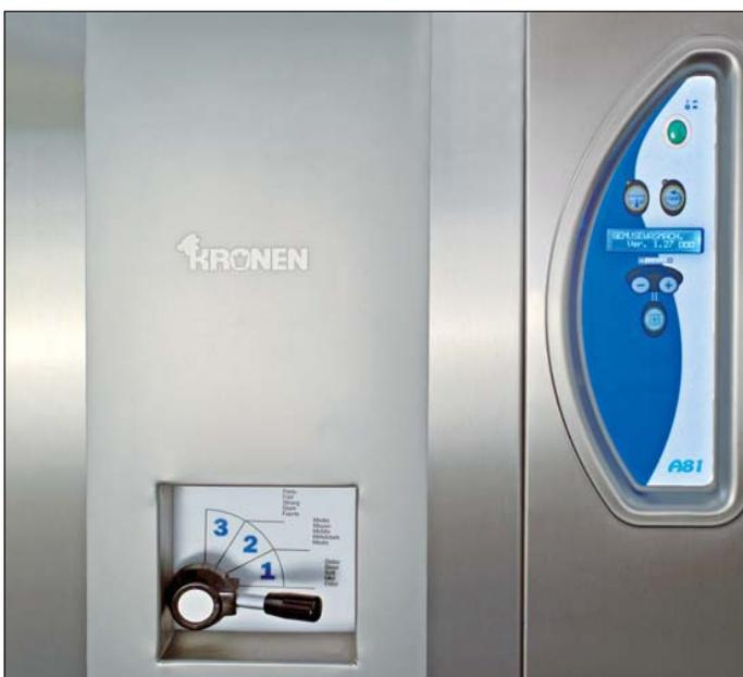
Einfachste Bedienung: Mit Plus-Minus das Programm wählen, Intensität einstellen – fertig. Das ist alles. Ach ja ... nach 7–12 Min. den Salat entnehmen.
