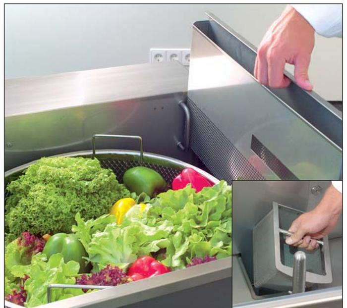
Insekten, Späne etc. schwimmen oben. Sand, Schmutz fällt nach unten. Das Filtersystem der KW-81A trägt dem Rechnung. Im Filter seitlich werden schwimmende Teile aufgefangen, im Filter unten sinkende Teile.
